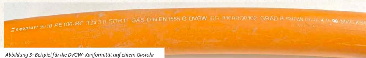
Abbildung 3- Beispiel für die DVGW- Konformität auf einem Gasrohr
